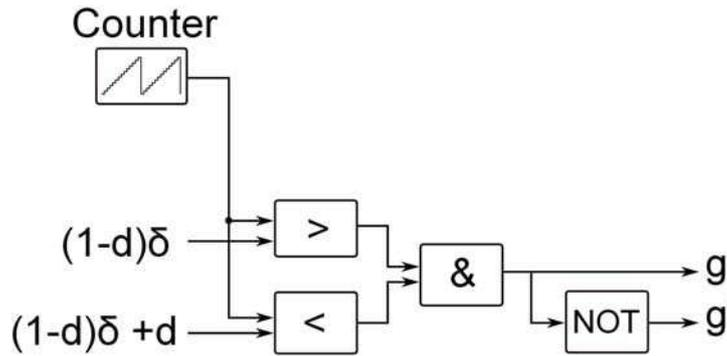
**Figure II-28: Pulse generator**
