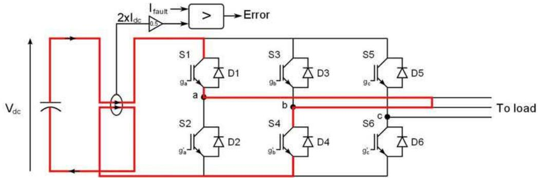
**Figure II-48: Phase short-circuit**
